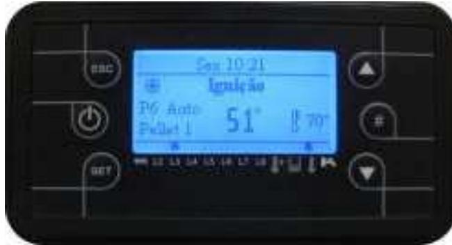
A caldeira entra em funcionamento automaticamente fazendo a ignição da combustão (até se notar a chama decorrem cerca de 4 - 8 minutos).
