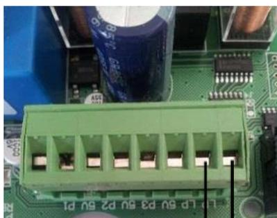
Quando o contacto K1 fecha aciona a Função TCC/PV e todas as fontes de calor ativas (Bomba de Calor + Resistência) são ajustadas para novos
